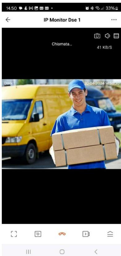
Per aprire la porta apri la toolbar completa e scegli SERRATURA. Puoi agire su 2 pulsanti che controllano le 2 serrature collegate alla pulsantiera.
